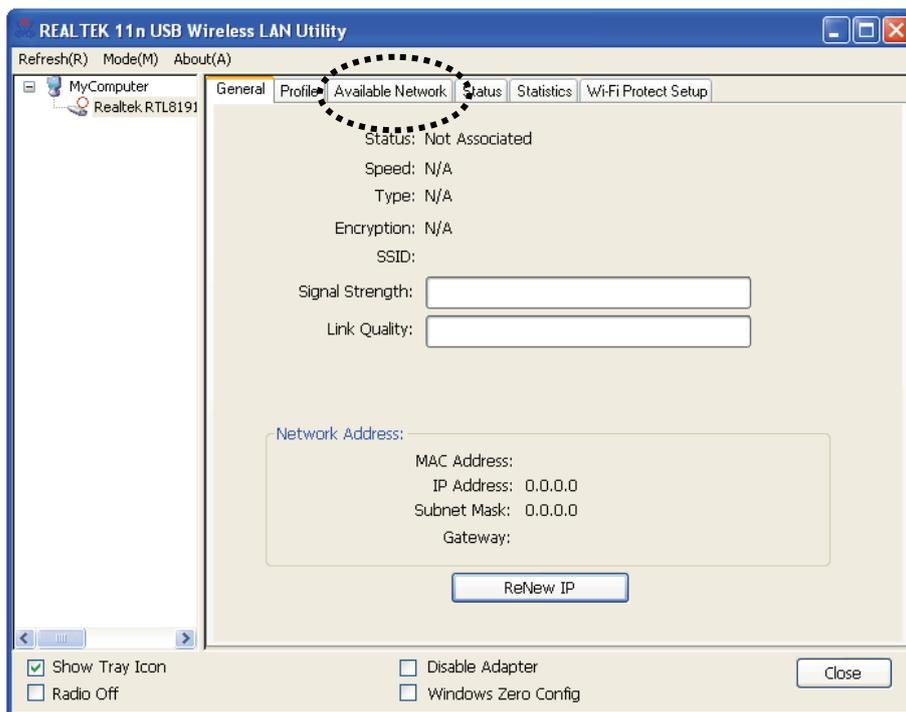
2. Откроется беспроводная утилита. Откройте закладку 'Available Network' для поиска расположенных рядом беспроводных точек доступа.
