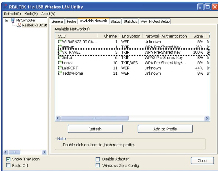
3. Пожалуйста, немного подождите и здесь появятся все беспроводные точки доступа в радиусе действия беспроводной сетевой карты.
