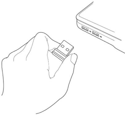
1. При включенном компьютере, вставьте беспроводную USB сетевую карту в свободный USB 2.0 порт вашего компьютера.
