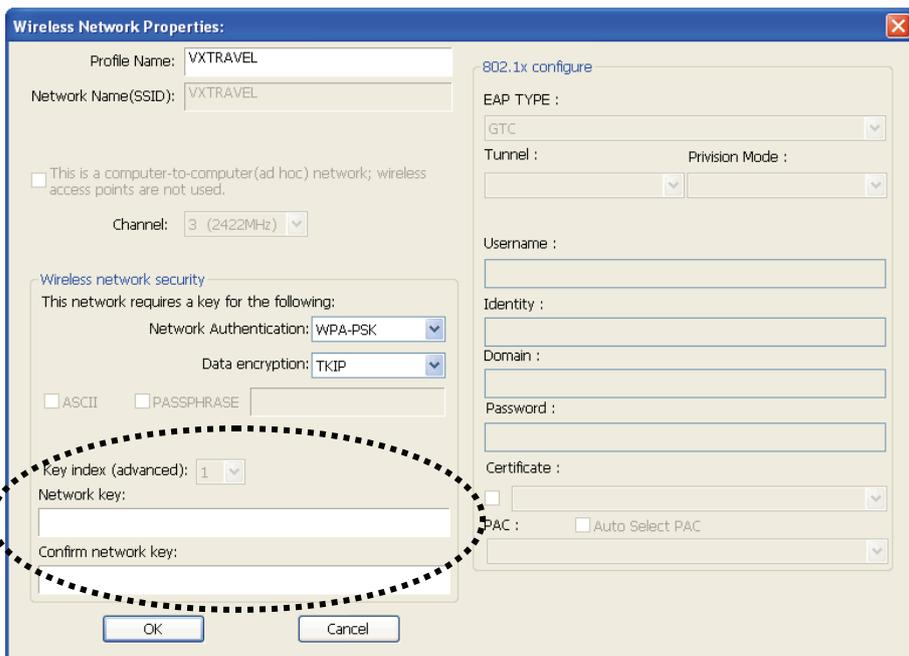
4. Если для подключения к беспроводной точке доступа потребуется пароль (он же 'Network Key'), пожалуйста, введите его в поле 'Network key' (затем еще раз в поле 'Confirm network key' для подтверждения). После того как пароль правильно введен нажмите 'OK'.
